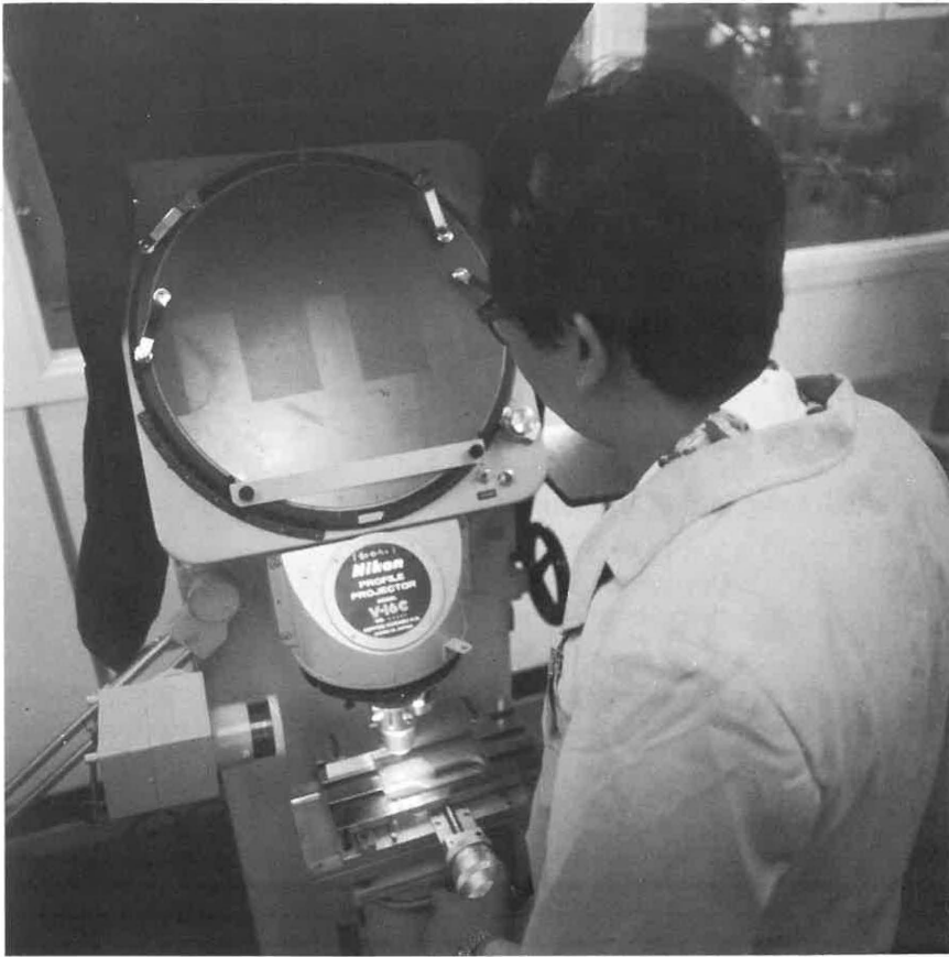
嘉士亞洲公司使用精確探射燈進行機床檢查。
